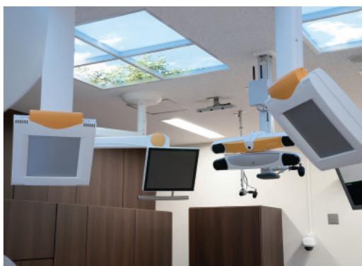
熊本大学病院の「TrueBeam Edge」には通常のkVイメージングシステムに加え、モニタリングシステム「ExacTrac (Brainlab社)」を導入。mm未満レベルでの高精度なSRT/SRSの実現を可能としている。
