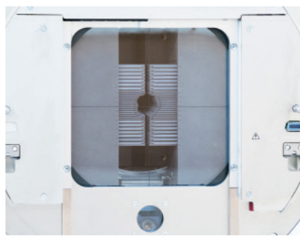
「TrueBeam Edge」に搭載されているマルチリーフコリメータは最小の25mm幅を有し、頭部への転移病変に対する高精度な定位照射が可能である。
